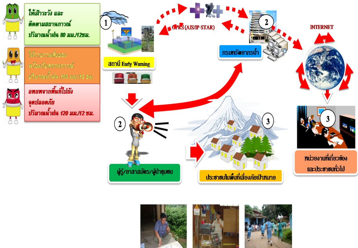
ภาพที่ 3.2 ผังการทำงานของระบบเตือนภัยล่วงหน้า (Early Warning)
